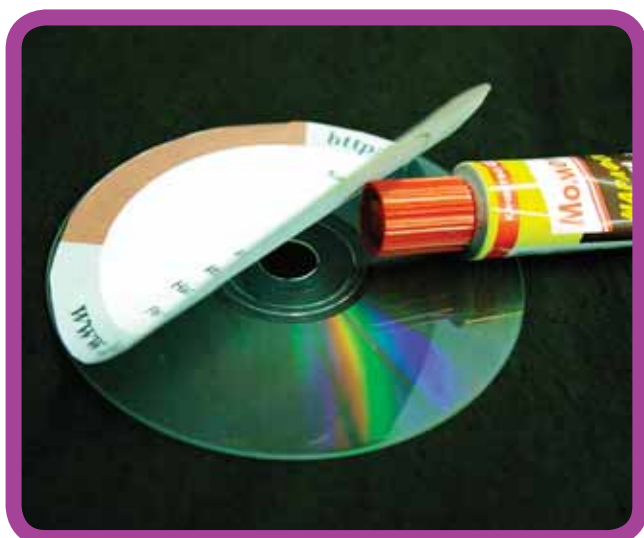
Рис. 6. Как показали испытания, клей «Момент» вполне подходит для такого дела, а вот ПВА – нет: фото «отпадает» через неделю
