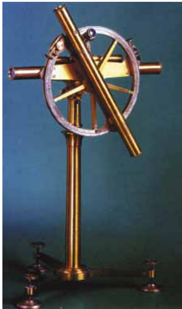
Повторительный круг Борда. На подставке указана фамилия оптика и механика Лемуара, мастерская которого находилась на Вандомской площади в Париже. XVIII в. Из коллекции учебно-геодезического музея МИИГАиК
