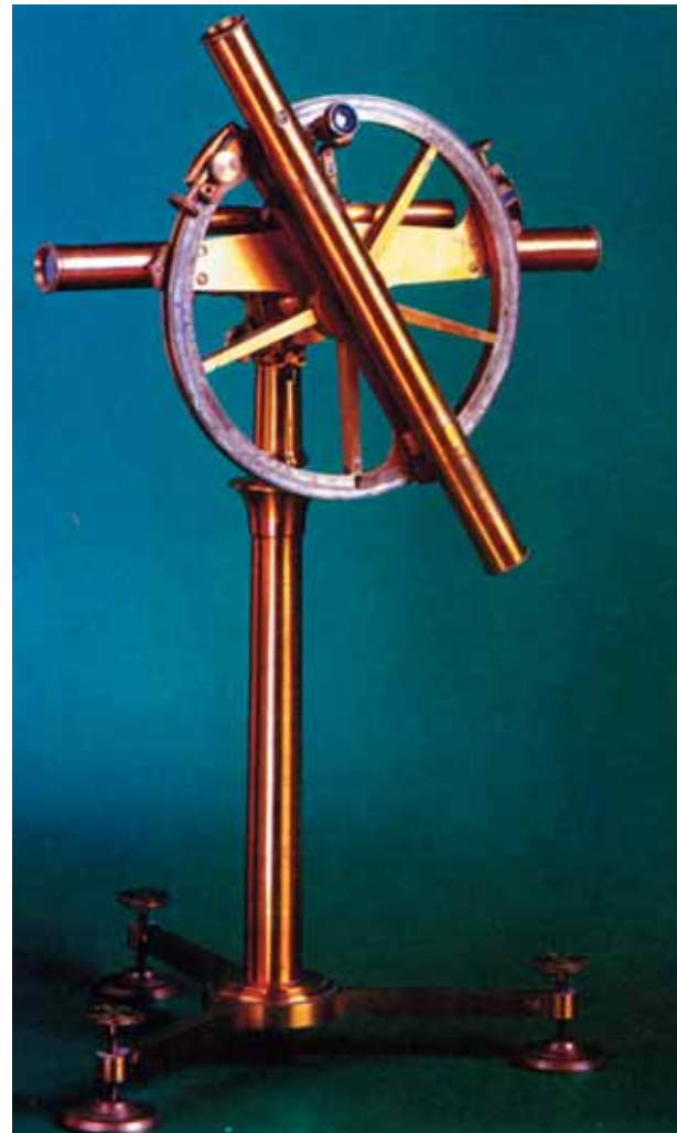
Повторительный круг Борда. На подставке указана фамилия оптика и механика Лемуара, мастерская которого находилась на Вандомской площади в Париже. XVIII в. Из коллекции учебно-геодезического музея МИИГАиК
