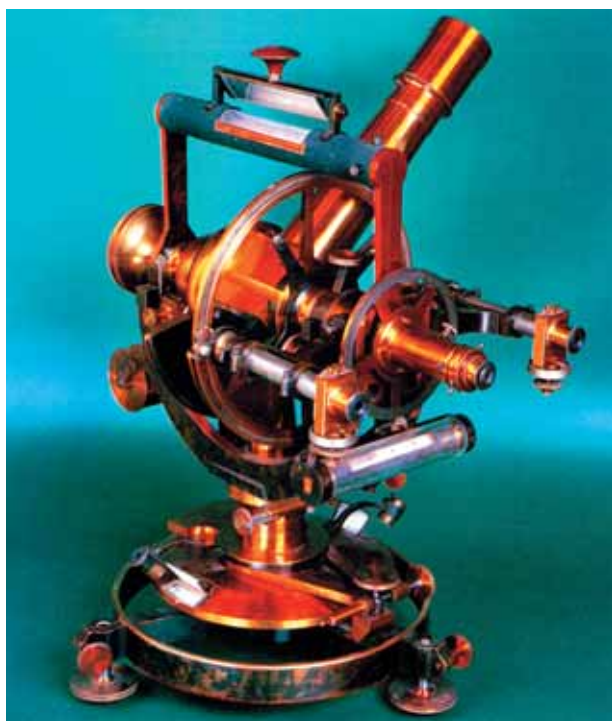
Астрономический универсал. Изготовлен в 1899–1904 годах в оптико-механической мастерской Пулковской обсерватории инженером-конструктором Г.А. Фрайберг-Кондратьевым. В эти же годы Фрайберг-Кондратьев сконструировал и изготовил ряд универсальных астрономических инструментов, позволявших выполнять все виды астрономических определений (широты, долготы и азимута). Пулковская механическая мастерская того времени выпускала астрономические инструменты, лучшие образцы которых превосходили зарубежные аналоги. Из коллекции учебно-геодезического музея МИИГАиК
